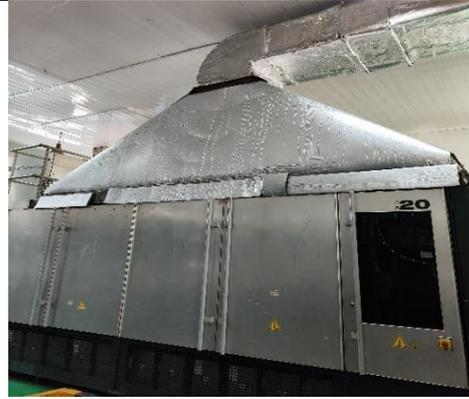
吹塑机加热炉
