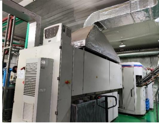
吹塑机加热炉
